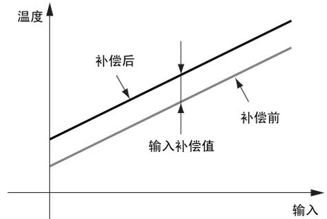
对于所有温度传感器测量范围的点、只有「温度输入补偿值」的设定值被进行输入补偿。
